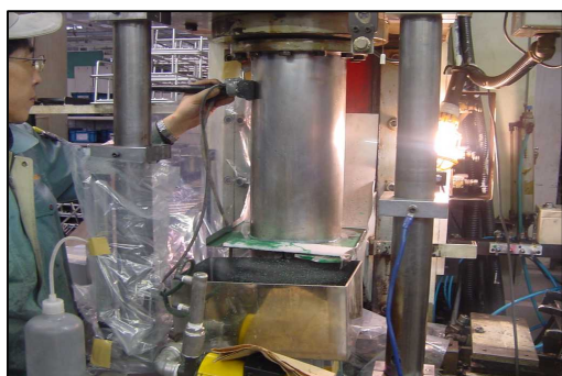
プレス機のクランクシャフトベアリング磨耗部の補修
